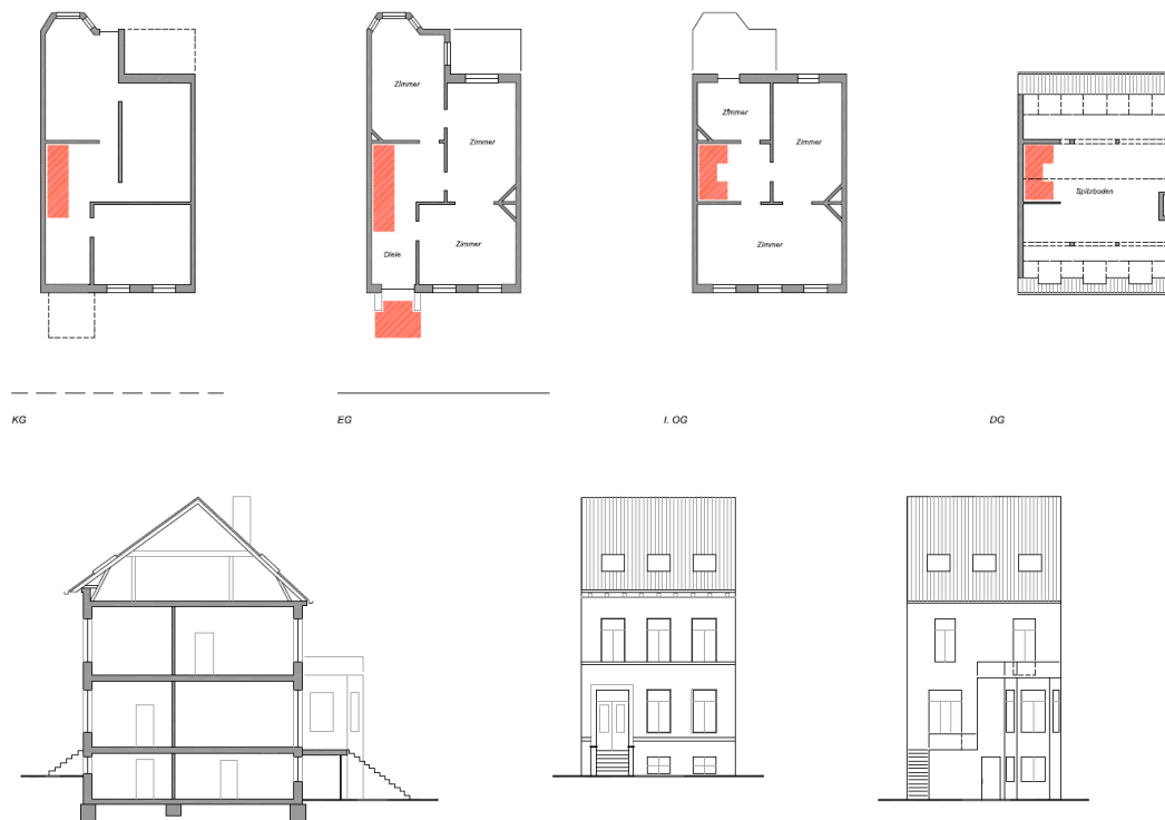
Abbildung 4-61 Schematische Zeichnungen des Gebäudetyp I, Maßstab ca. 1:400
