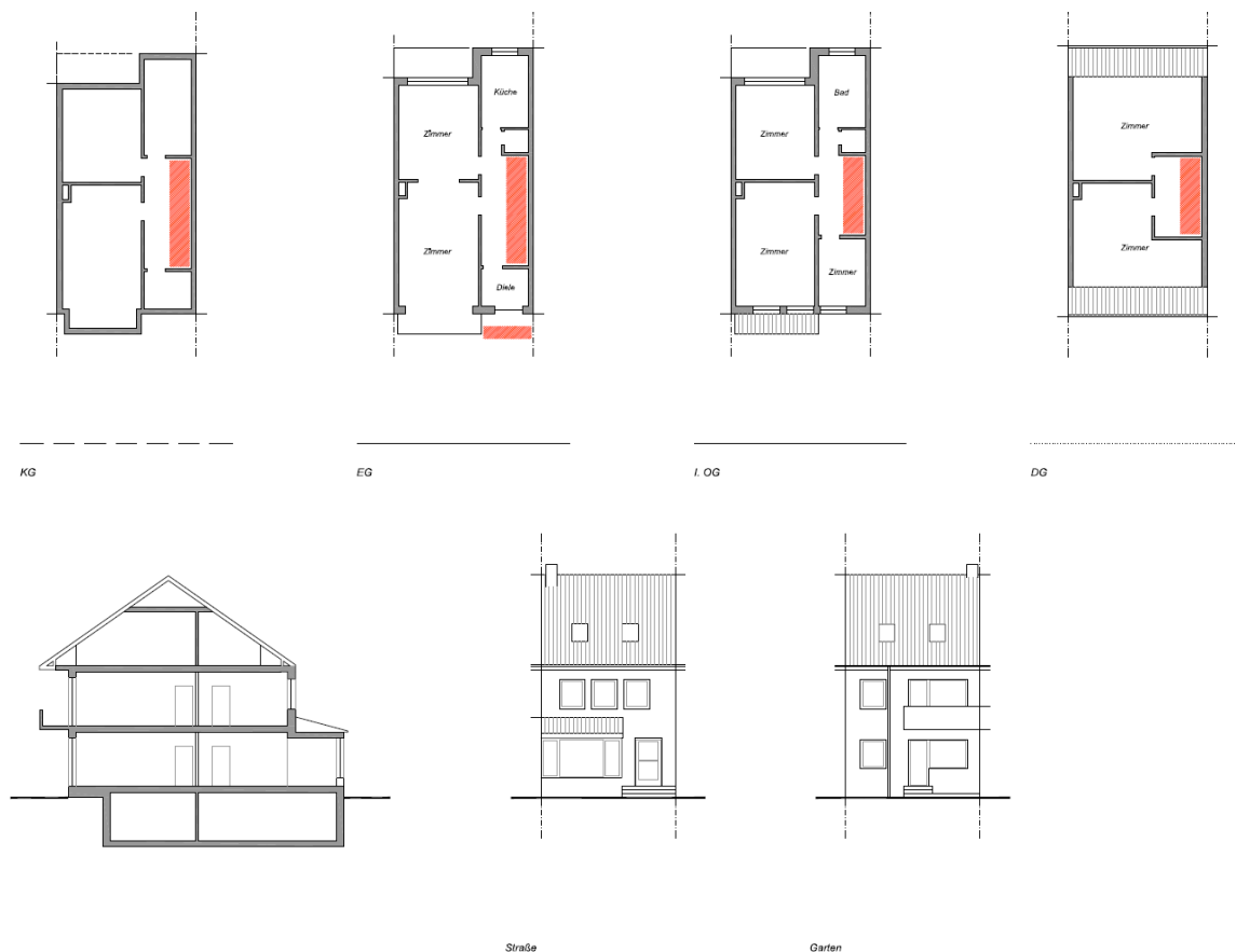
Abbildung 4-104 Schematische Zeichnungen des Gebäudetyp I, Maßstab ca. 1: 400
