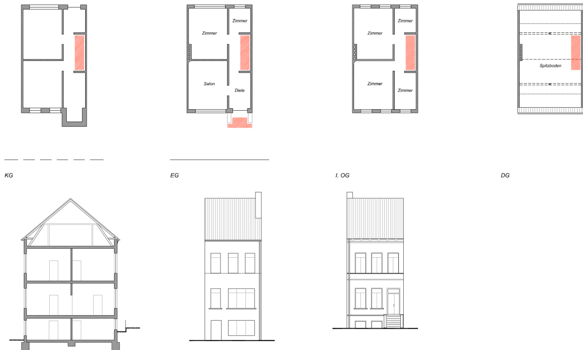
Abbildung 4-3 Standardgebäude, Grundrisse, Schnitt- und Ansichtszeichnungen 11
