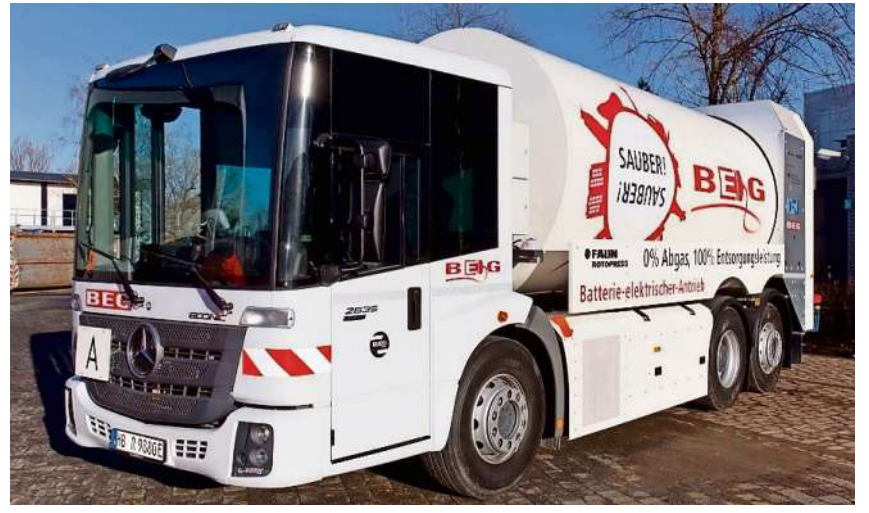
Die Batterien des rein elektrisch betriebenen Müllfahrzeugs laufen mit aus Müll erzeugtem CO 2 -neutralem Strom. Foto: BEG
