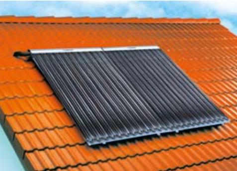
▲ Neue Flachkollektoren sind mit einer speziellen selektiven Beschichtung versehen, um einen möglichst hohen Anteil an Solarenergie in Form von Wärme zu absorbieren. Vakuumröhrenkollektoren hingegen machen sich das bewährte „Thermoskannenprinzip“ zunutze.
