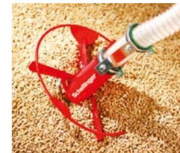
▲ Der Pellet-Maulwurf bewegt sich aktiv. Er wandert die Böschungen ab, kommt bis in jede Ecke des Tanks und entleert ihn systematisch von oben nach unten. Das bringt entscheidenden Platzgewinn und schützt zugleich die Qualität der Pellets. Der Maulwurf eignet sich für alle Holzpelletheizungen mit Saugsystem.
