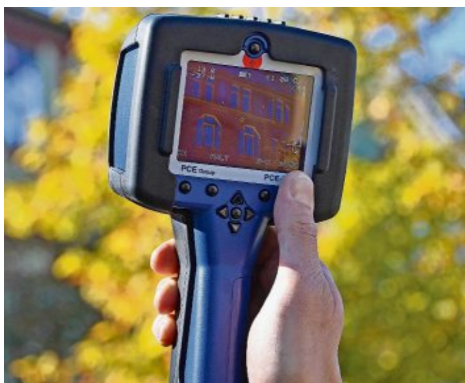
Mit der speziellen Wärmebildkamera lassen sich schnell Wärmelecks in den Häusern entdecken.
