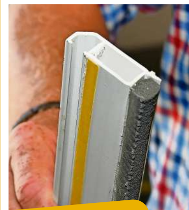
Die 3. Ebene muss über einen Schlagregenschutz verfügen und diffusions-offen sein, damit Feuchtigkeit entweichen kann. In diesem Beispiel ist eine Hohlkammerleiste aus Kunststoff mit einem vor-komprimierten Dichtungsband zu sehen.
